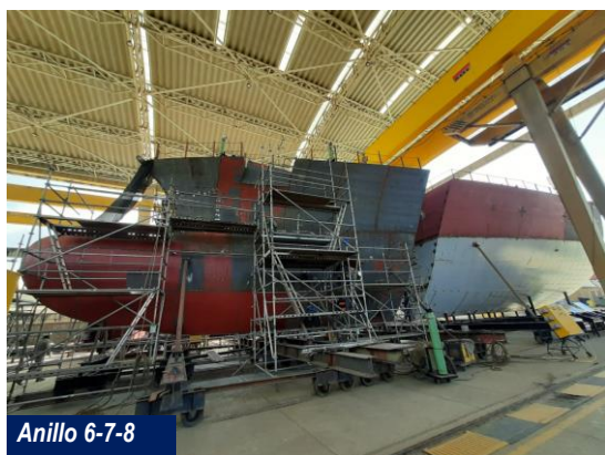
Ilustración 23. Avance proceso construcción Patrullera Oceánica Colombiana (POC)
